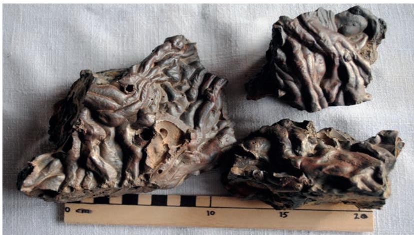
Photo 3 : Scories ou « laitiers », résidus de l'extraction du fer. Echantillons provenant du Salève (en bas à dr.) et de Mont-Chemin (VS) (éch. cm).
