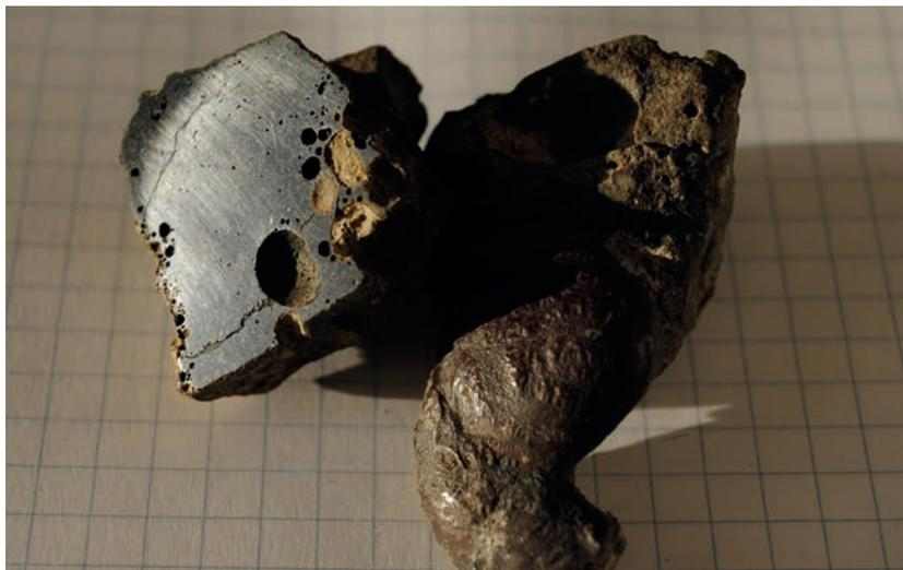
Photo 4 : La section coupée et polie de la scorie de Carniol, prête pour l'analyse par fluorescence X.
